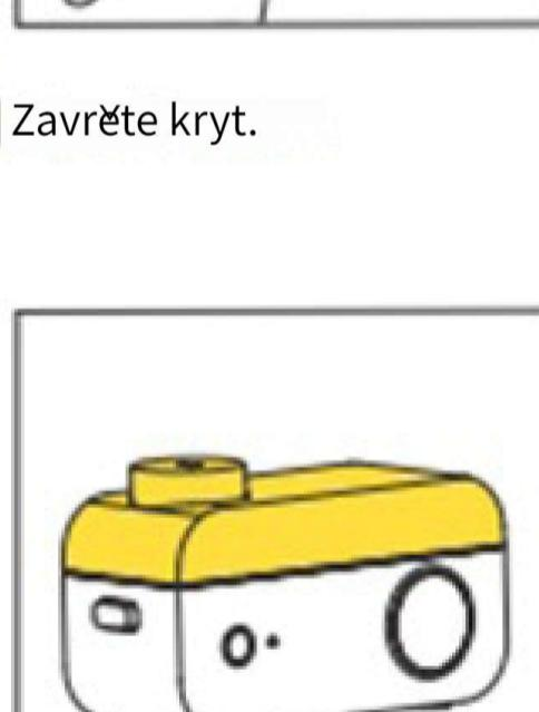
**05** Vytáhněte papír s etiketou a zatáhněte Zavřete kryt. na znacku na výstupu aby se dal normálně vytisknout
